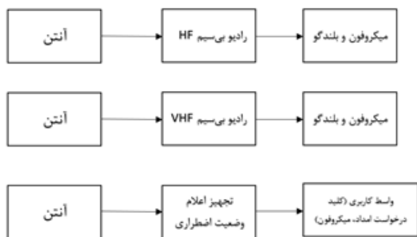
شکل ۷. ارتباطات داخلی سامانه ارتباطات بی‌سیم شناورهای آب‌های ساحلی
