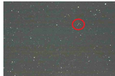
شکل 5: نمایش ماهواره به صورت یک رگه نورانی در تصویر گرفته توسط حسگر دوربین که در سطح زمین قرار گرفته است [25].
