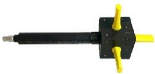
شکل ۷. چیدمان سه آنتن عمود بر هم برای دریافت ایزوتروپیک میدان‌های الکتریکی
